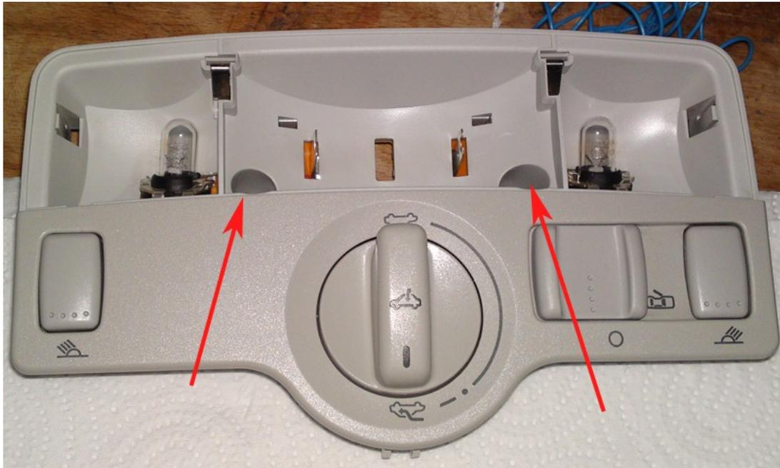
Als nächstes klipst man das Poti aus dem Gehäuse und öffnet es. Das Poti wird nur von kleinen Nippeln zusammen gehalten. Einfach mit einem kleinen Schraubendreher die Nippel rein drücken und das untere Teil vom Gehäuse lösen. Das ganze müsste dann etwa so aussehen (siehe Bild unten)
